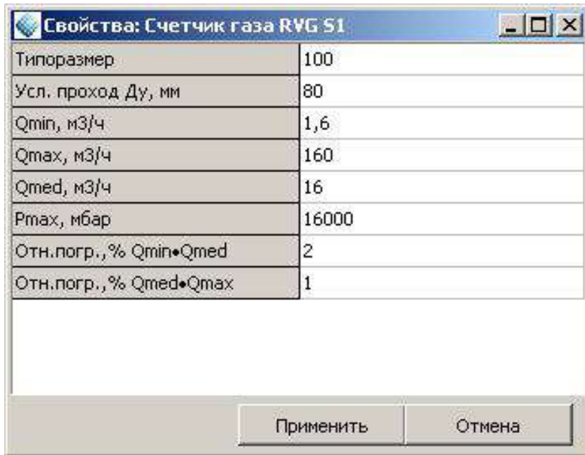
Рисунок 5 – Параметры нового добавляемого счетчика.
