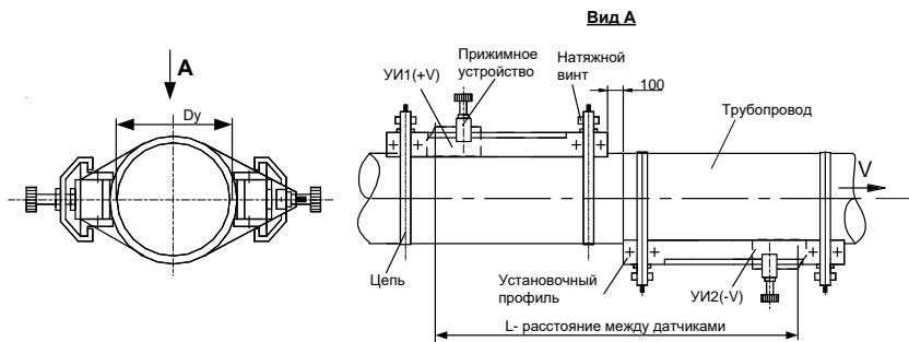
**Вариант крепления с помощью зажима**
