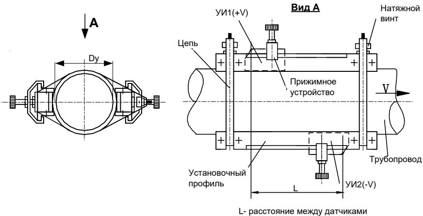
**Вариант крепления с помощью зажима**
