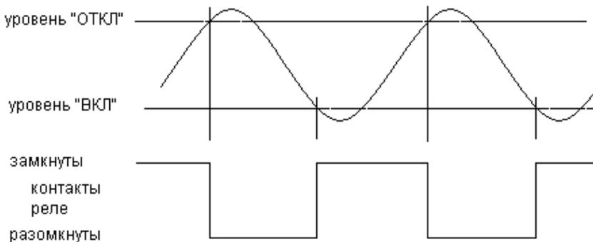
Режим 1 предназначен для включения насосов для откачки жидкости из резервуара для защиты от переполнения и выключения насосов при его опустошении. Этот режим используется на канализационных насосных станциях (КНС).
