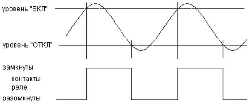
**В режиме 2** контакты реле замыкаются при уровне больше значения "ОТКЛ" и размыкаются при уровне меньше значения "ВКЛ" (уровень включения ниже уровня отключения):
