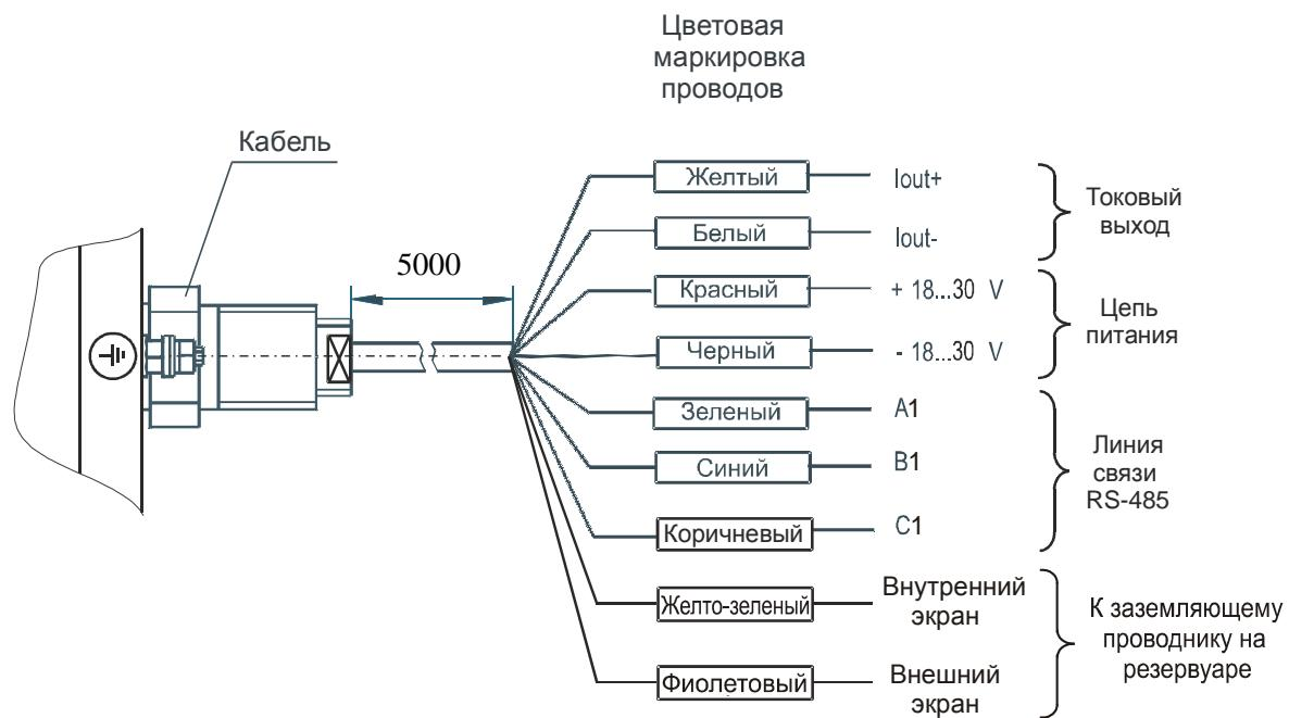
Рисунок 10 – Маркировка и назначение жил кабеля
