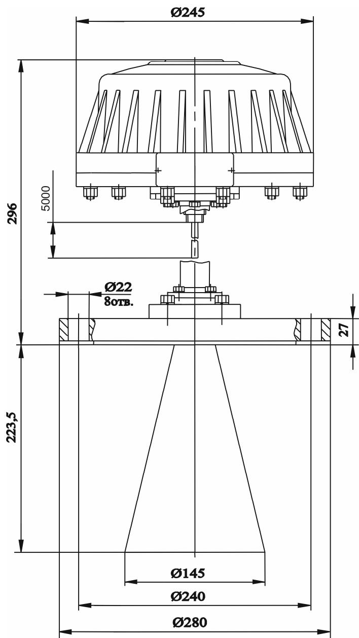
Рисунок Б.4 - Габаритные и установочные размеры прибора БАРС 351И.06А
