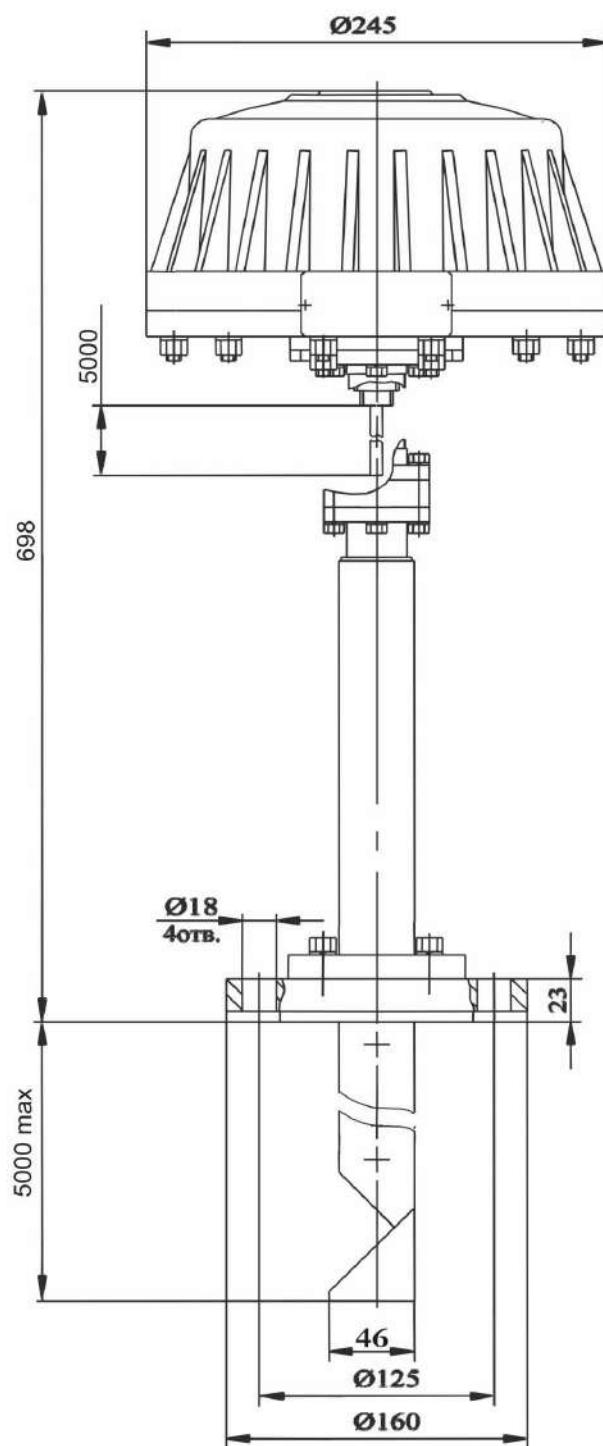
Рисунок Б.9 - Габаритные и установочные размеры прибора БАРС 351 И.16А
