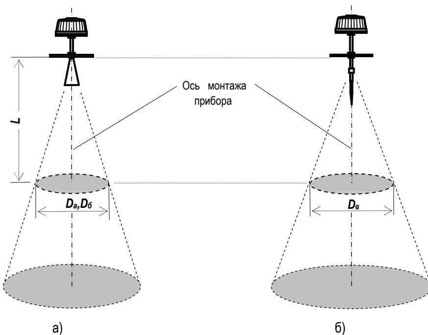
Рисунок 4 - Определение диаметра облучаемой поверхности у приборов с различными типами антенн: а) рупорная антenna ( $D_a$  и  $D_b$  – для антенн с диаметром раскрыва 145 мм и 120 мм соответственно); б) стержневая антна
