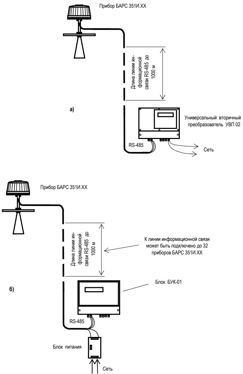
Рисунок 12 - Подключение прибора к внешним устройствам:
