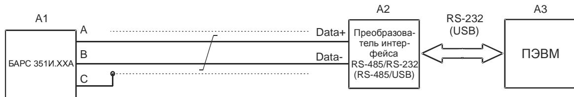
Рисунок В.1- Общее правило подключения прибора к линии информационной связи, преобразователю интерфейса и ПЭВМ
