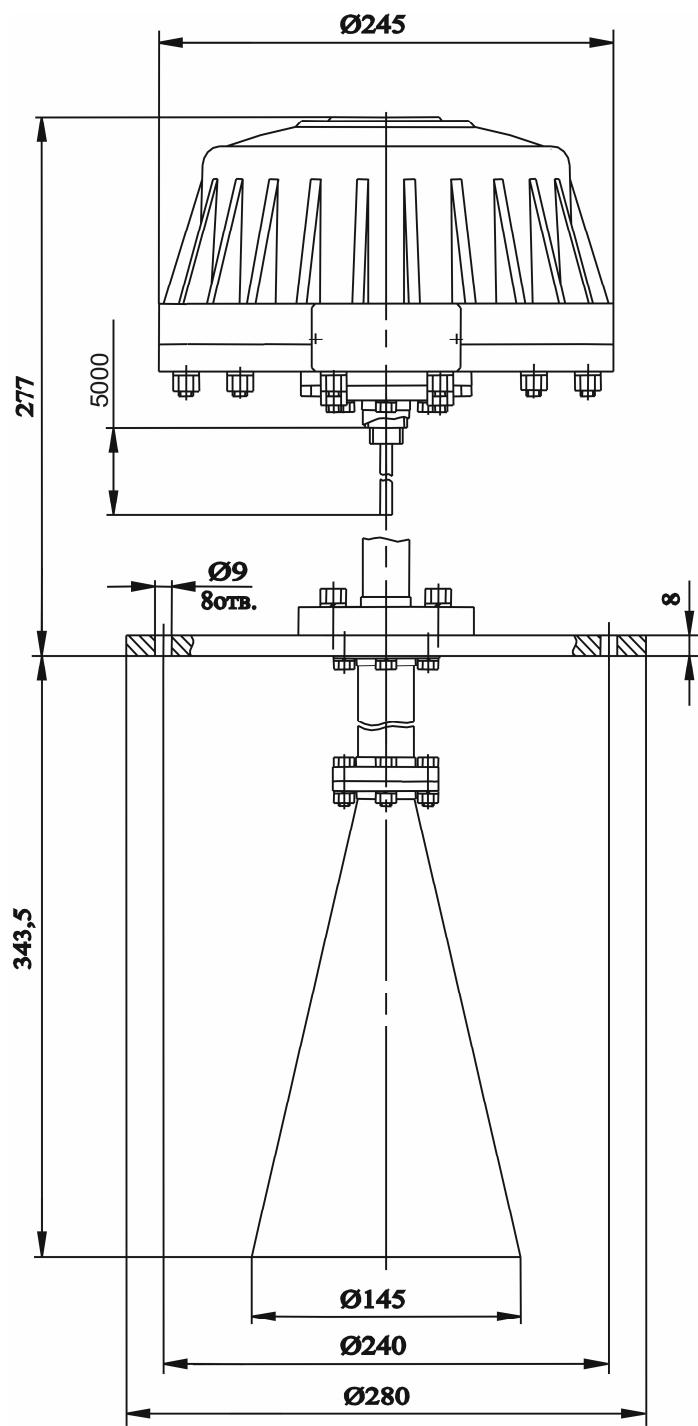
Рисунок Б.2 - Габаритные и установочные размеры прибора БАРС 351И.02А
