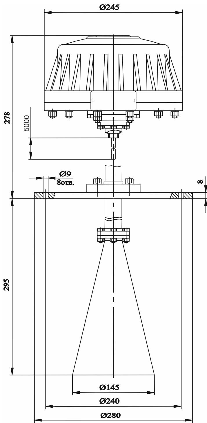
Рисунок Б.3 - Габаритные и установочные размеры прибора БАРС 351И.04А
