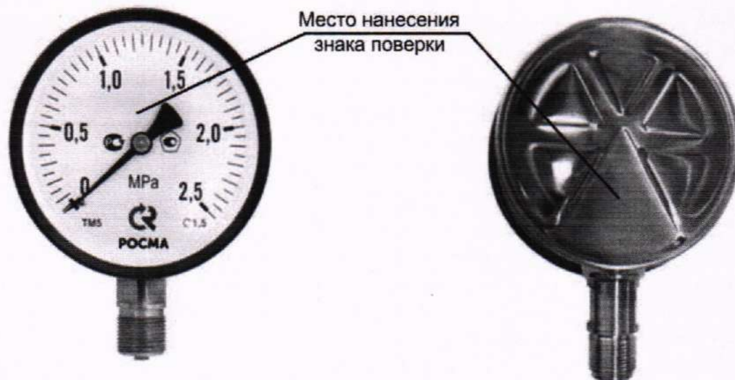
Рисунок 1 – Места нанесения знака поверки на корпус средства измерений
