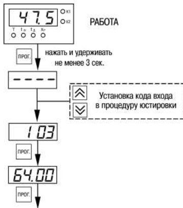
Рисунок 8.4 – Последовательность работы при юстировке
