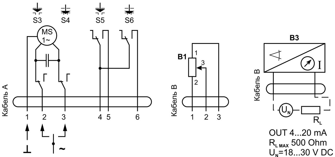
Рис. 8-6. Схема электрических соединений для электроприводов SP MIKRO.
