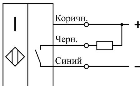
*Схема подключения индуктивной нагрузки*
