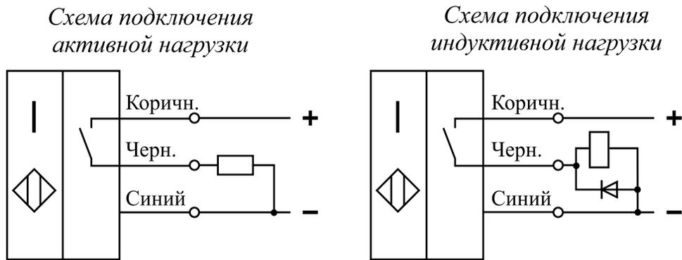
Рис. 8-26. Схема подключения датчиков со структурой Р (рпр - “общий -”) (для датчиков ВК WF63-31-Р-3-400-ИНД-3В-1-НТ или ВК WF63-31-Р-3-400-ИНД-3В-1-НТ2)
