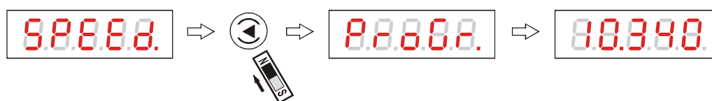
Рисунок 83 - Запись в память уровнемера введенных установочных параметров
