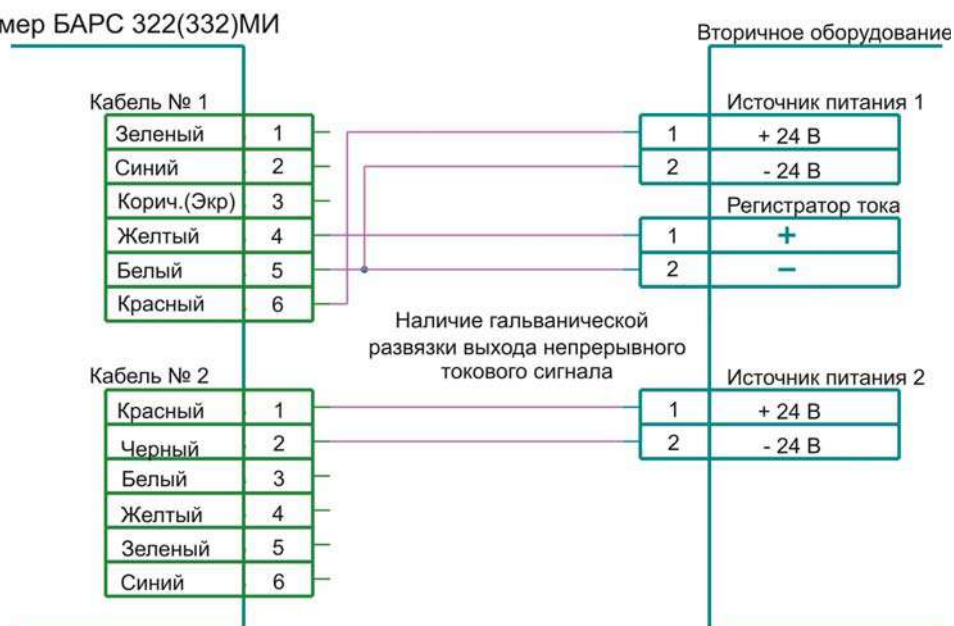
Рисунок Б.4 – Подключение цепей питания и выхода непрерывного токового сигнала
