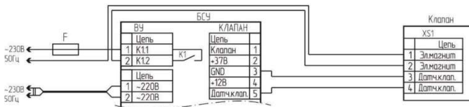
Рисунок А.2 – Типовая схема подключения для управления вентиляцией
