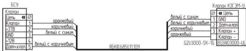
Рисунок А.5 – Схема подключения клапана КЗГЭМ-У с разъемом BG5N03000-UL.
