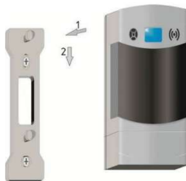
Рисунок Г.2 – Установка БСУ на монтажную панель
