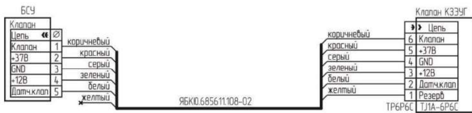
Рисунок А.7 – Схема подключения клапана КЗЭУГ с разъемом TJ1A-6P6C.
