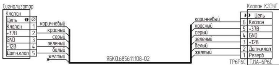
Рисунок В.6 – Схема подключения клапана КЗЭУГ с разъемом TJ1A-6P6C к сигнализатору с разъемами 15EDGLC-3,5
