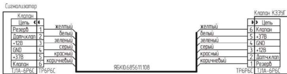
Рисунок В.9 – Схема подключения клапана КЗЭУГ с разъемом Т1А-6Р6С к сигнализатору с разъемами Т1А-6Р6С.
