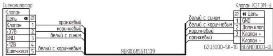
Рисунок В.4 – Схема подключения КЗГЭМ-У с разъемом BG5NO3000-UL.
