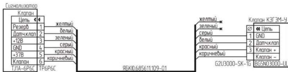
Рисунок В.8 – Схема подключения КЗГЭМ-У с разъемом В65НО3000-UL к сигнализатору с разъемами Т1А-6Р6С.
