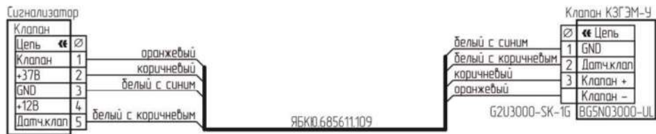
Рисунок В.4 – Схема подключения клапана КЗГЭМ-У с разъемом BG5N03000-UL.
