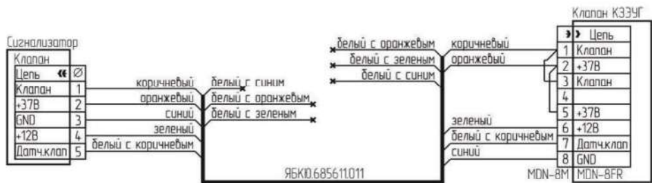
Рисунок В.5 – Схема подключения клапана КЗЭУГ с разъемом MDN8FR.
