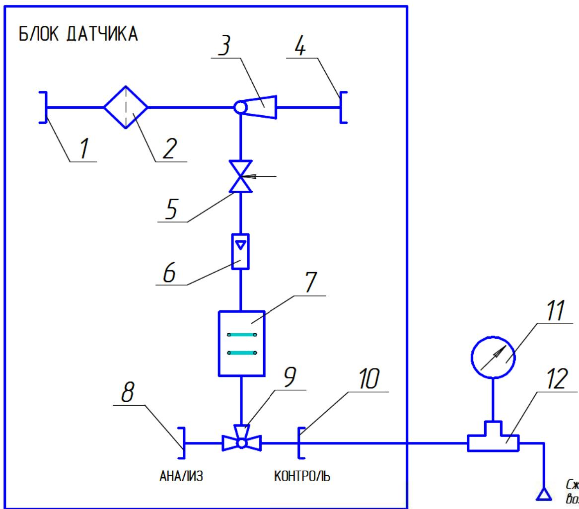
Рисунок А.3 – Схема для проверки герметичности
