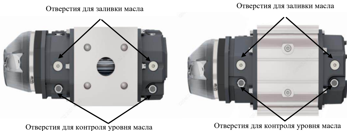
Рисунок 15. Заливка и контроль уровня масла при установке счетчика G10-G400 на горизонтальном участке трубопровода
