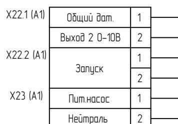
Рисунок Е.1. Схема электрическая принципиальная горелки
