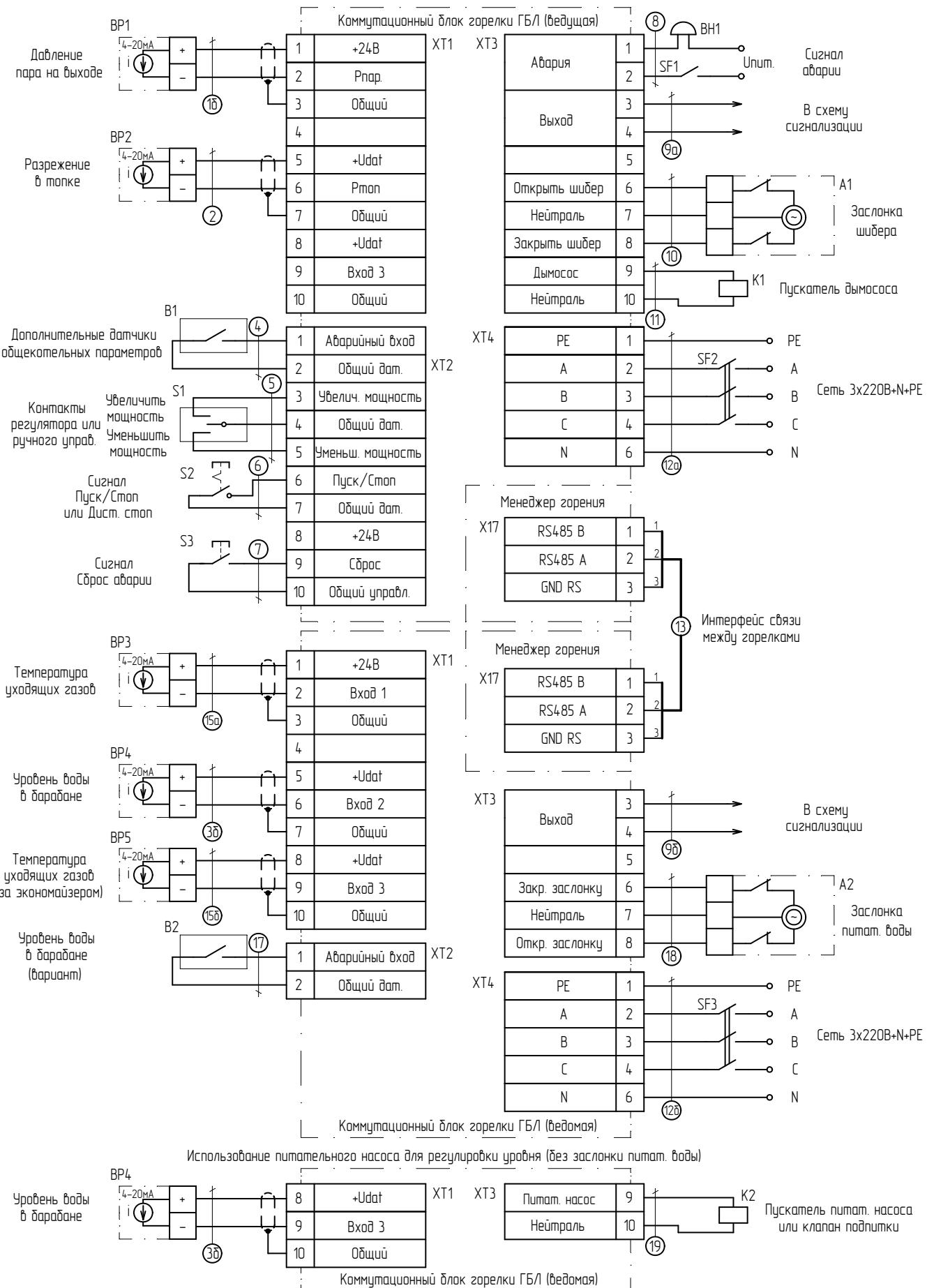
Рис. Л.2 Схема подключений двухгорелочного котла типа ДКВР в паровом режиме
