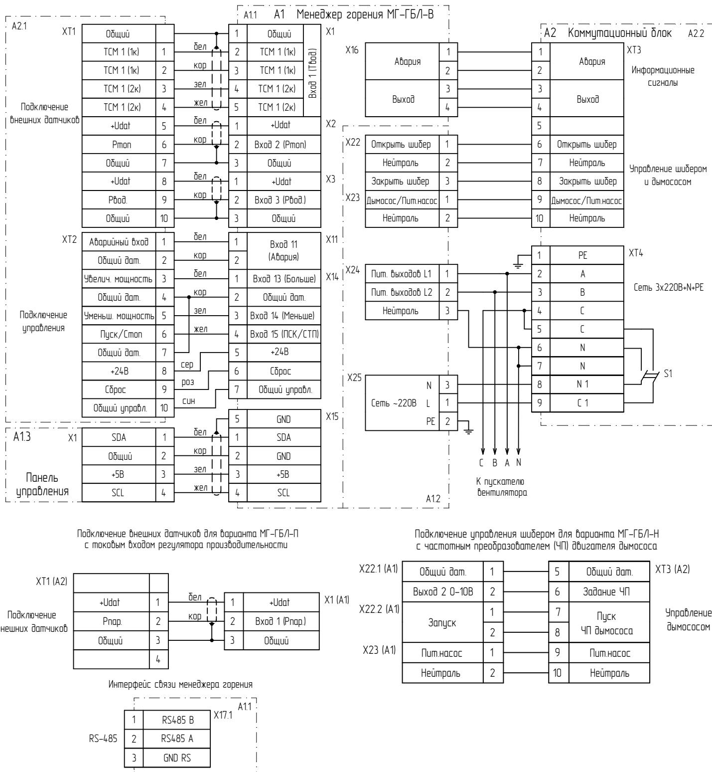
**Рисунок Е.1. Схема электрическая принципиальная горелки (соединения с коммутационным блоком)**
