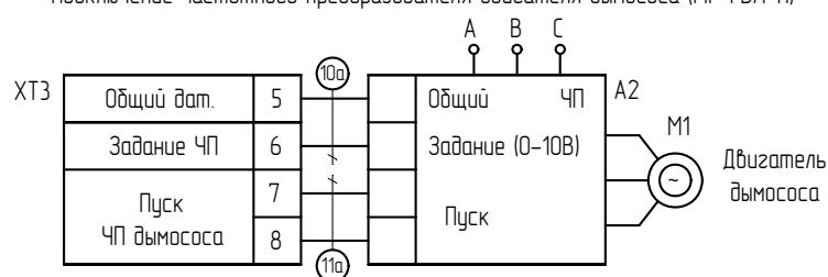
Рис.Ж.1 Схема подключения горелки
