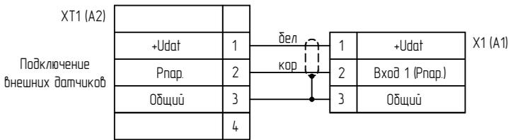
Подключение управления шиберам для варианта МГ-ГБЛ-Н с частотным преобразователем (ЧП) двигателя дымососа
