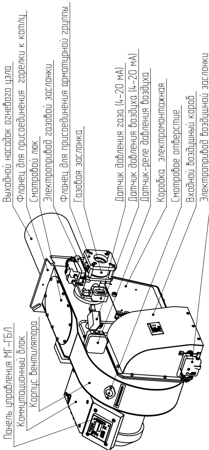
Рисунок А.1. Общий вид горелки
