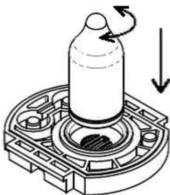
Рисунок 4.4 – Установка УФЛ в камеру ионизационную
