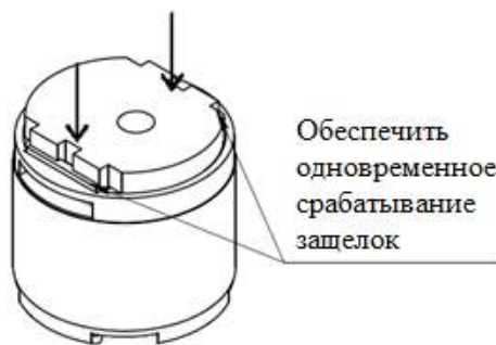
Рисунок 4.5 - Установка камеры ионизационной в ФИД
