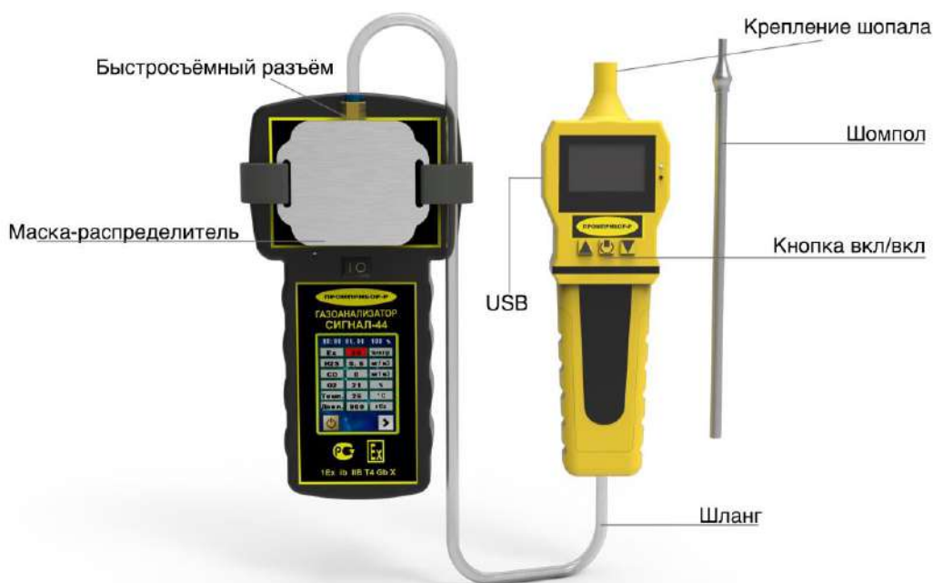
Рис.6. Схема соединения зонда для принудительного отбора пробы
