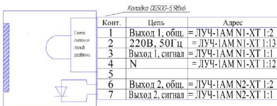
Рис.8. Выходные электрические цепи фотодатчика ФД-05ГМ.
