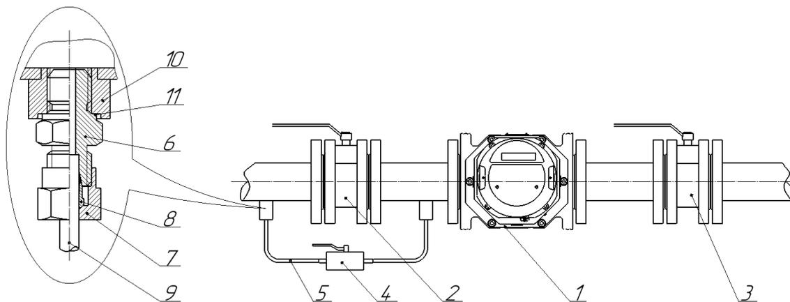
Рисунок 2 – Установка счетчика с перепускным каналом
