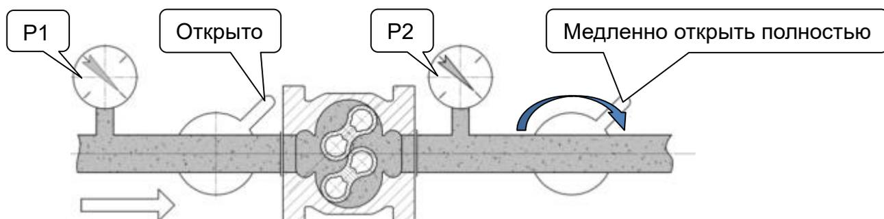
Рисунок 6 – Окончательный запуск
