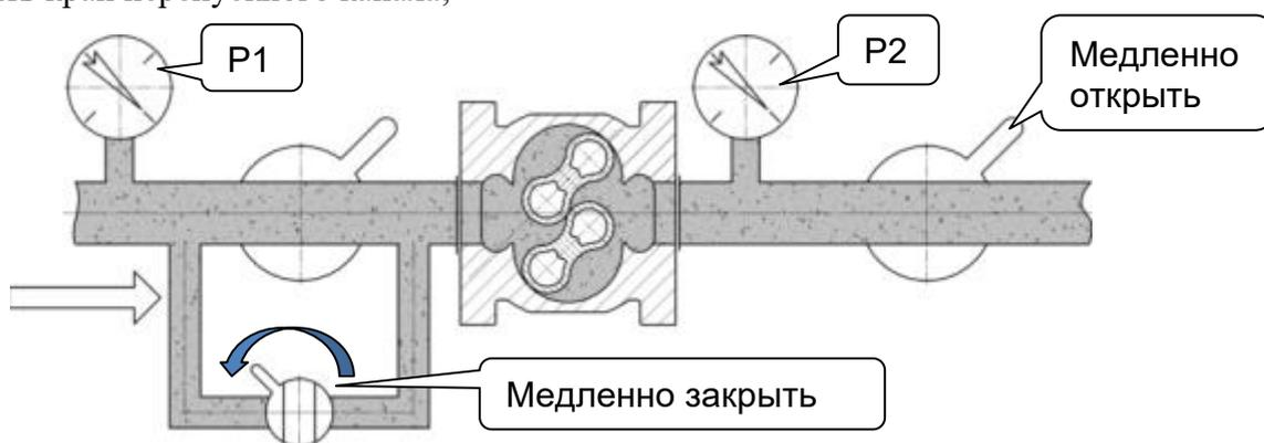
Рисунок 9 – Окончательный запуск
