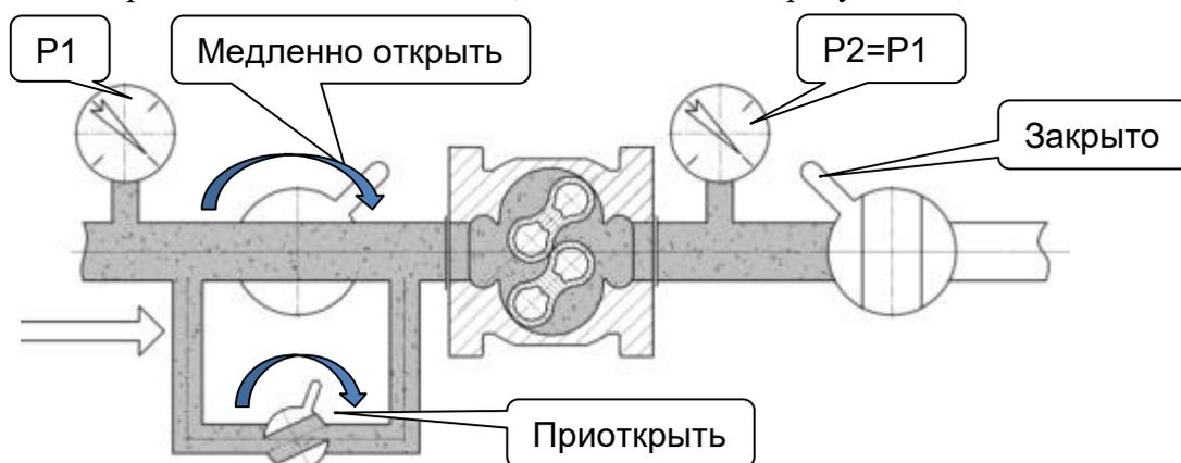
Рисунок 8 – Открытие запорного устройства до счетчика
