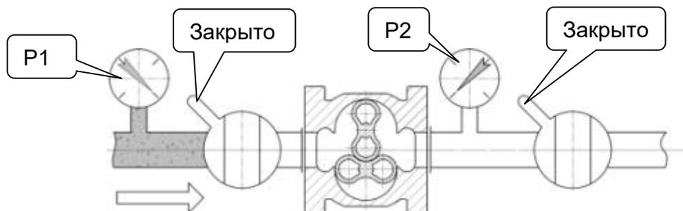
Рисунок 3 – Положение запорных устройств до начала пуска
