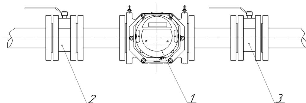
Рисунок 1 – Установка счетчика без перепускного канала
