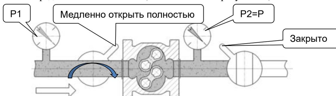
Рисунок 5 – Полное открытие запорного устройства до счетчика
