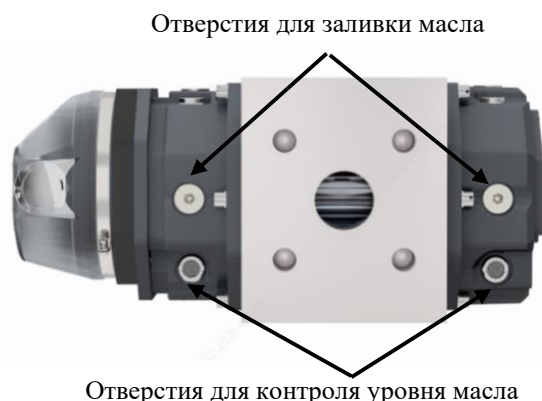
Рисунок 23. Заливка и контроль уровня масла при установке счетчика G16-G400 на горизонтальном участке трубопровода
