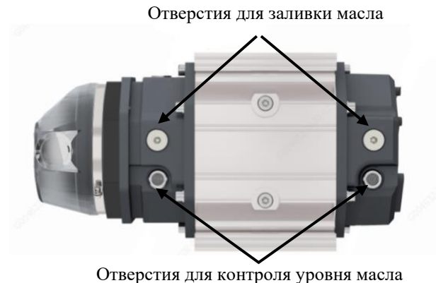
Рисунок 24. Заливка и контроль уровня масла при установке счетчика G16-G400 на вертикальном участке трубопровода
