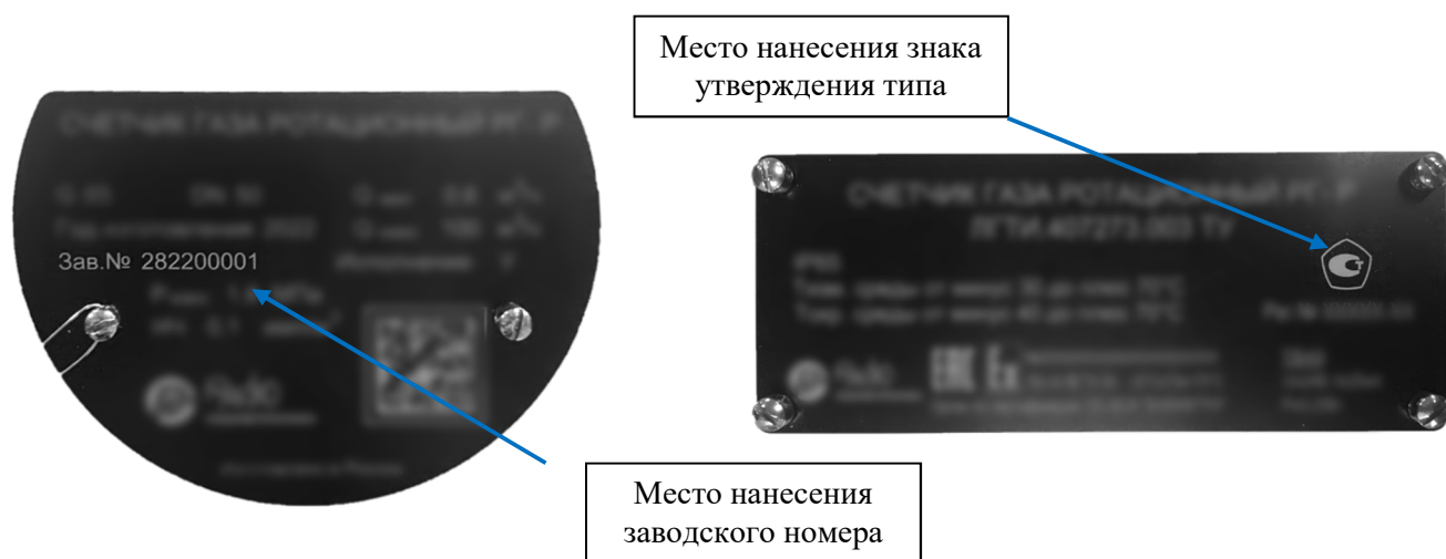
Рисунок 2 – Места нанесения заводского номера, знака утверждения типа
