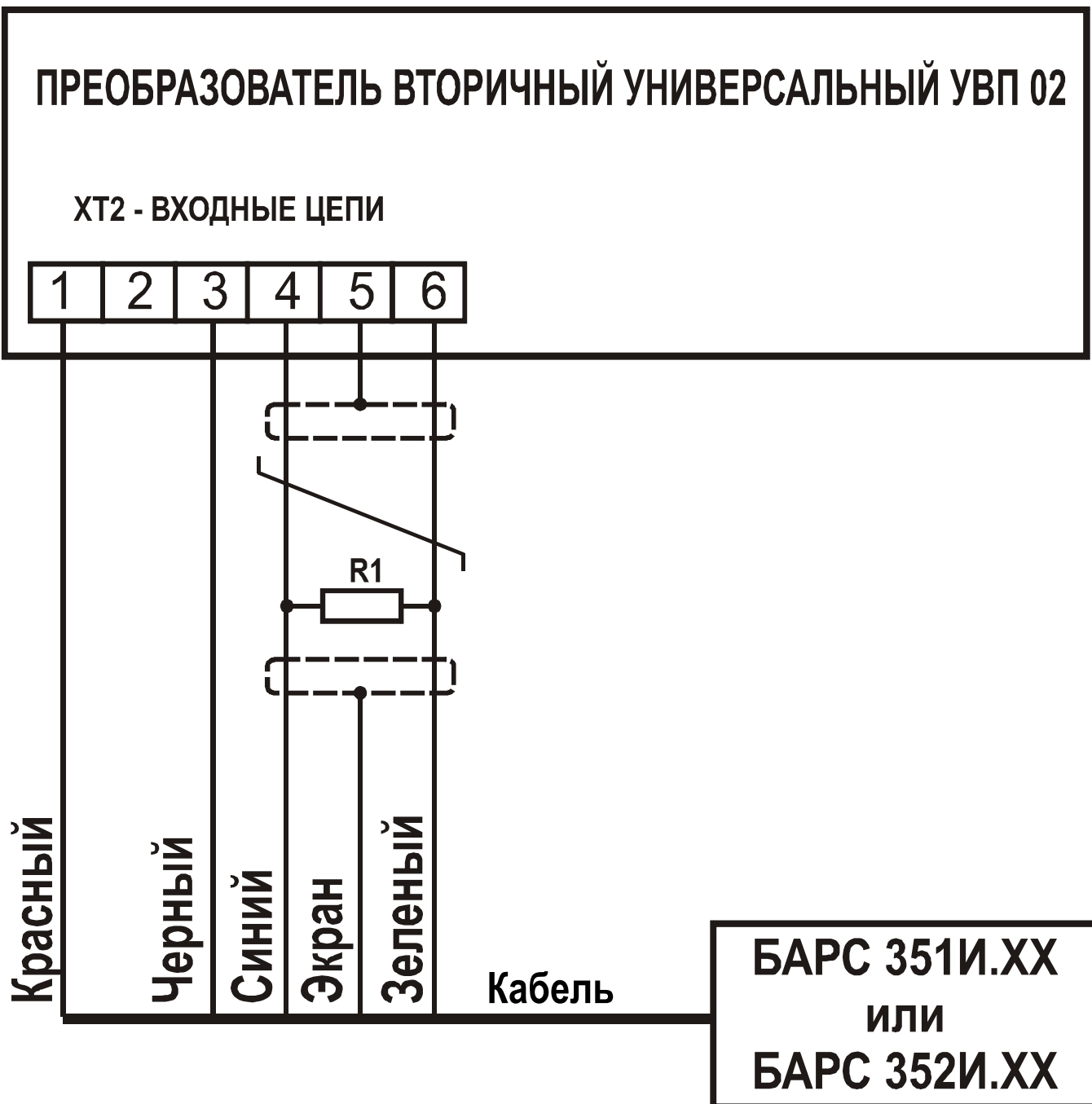
Рисунок К.1 – Схема подключения радиоволновых преобразователей уровня исполнений БАРС 351И.00, БАРС 351И.02...БАРС 351И.18 и исполнений БАРС 352И.00, БАРС 352И.02... БАРС 352И.18 к прибору
