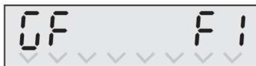
Рисунок 2.72 – Режим работы с одним счетным входом
