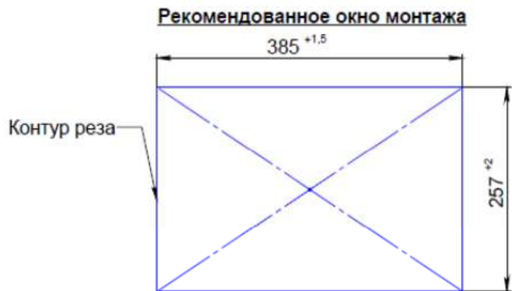
Рисунок 3. Габаритные размеры и размеры выреза в щите АГАВА ПК-50.15
