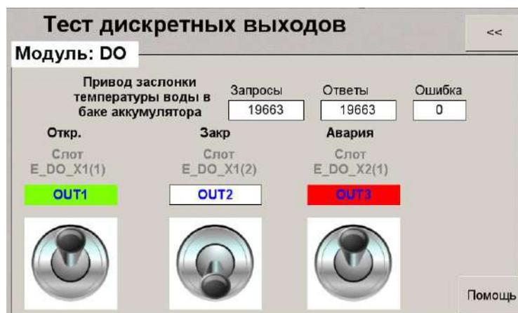
Рисунок 4.16. Окно проверки выходов submodule DO
