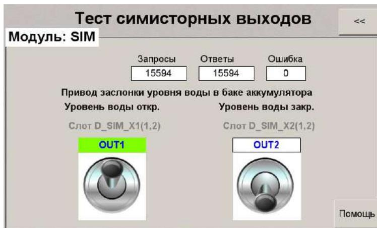
Рисунок 4.15. Окно проверки выходов submodule SIM
