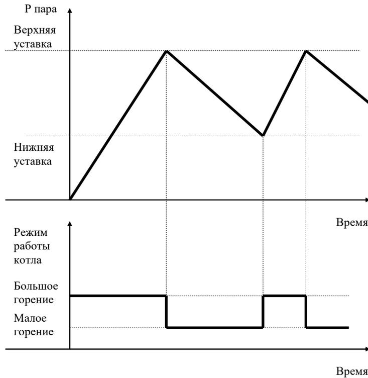
**Рисунок Г.1 – График позиционного регулирования мощности котла**
