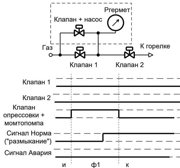
**Рисунок 6 – Выполнение контроля герметичности с помощью внешнего устройства**
