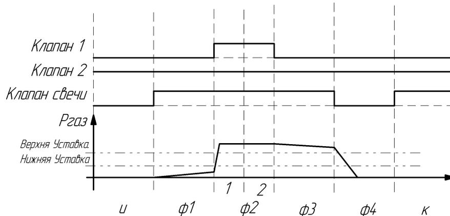
**Рисунок 4 – Выполнение контроля герметичности по 2 уставкам**
