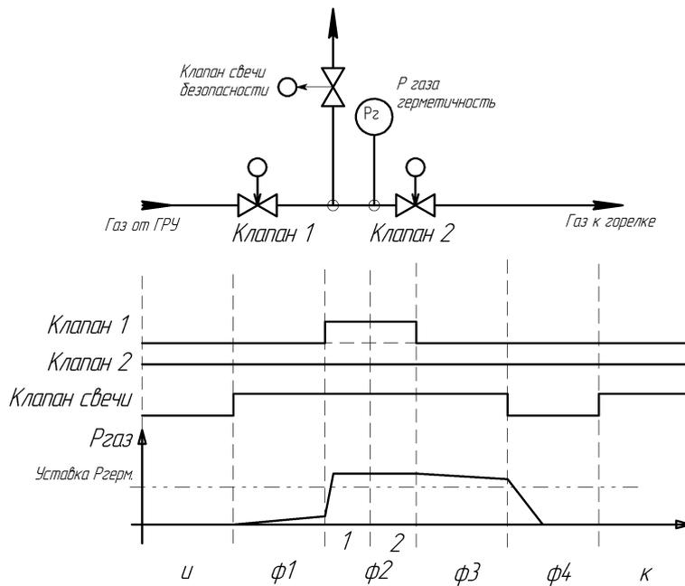
**Рисунок 3 – Выполнение контроля герметичности по одной уставке**
