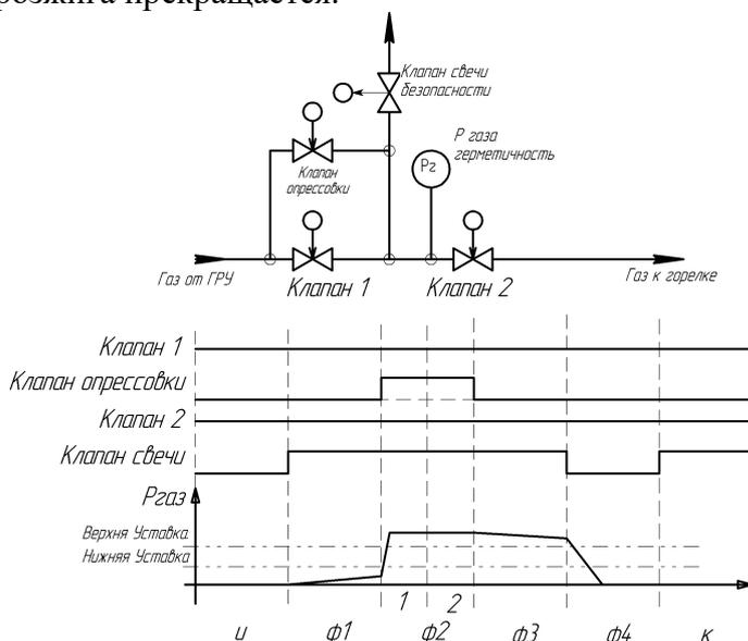
**Рисунок 5 – Выполнение контроля герметичности по 2 уставкам (АМАКС)**
