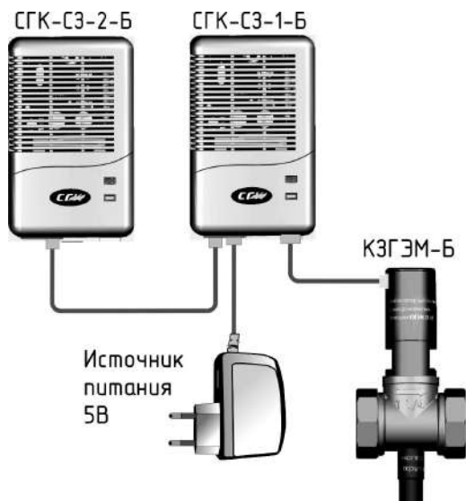
Рис. 5. – Система автономного контроля загазованности СГК-2-Б.
