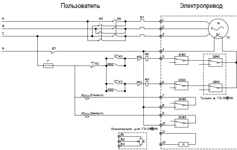
Рис. 36. Принципиальная электрическая схема подключения электроприводов ГЗ-ОФБ(К) и ГЗ-ОФБ(М) к сети 3 x 380 В, 50 Гц.
