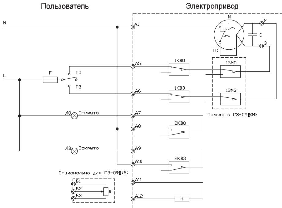
Рис. За. Принципиальная электрическая схема подключения электроприводов ГЗ-ОФБ(К) и ГЗ-ОФБ(М) к сети 220 В, 50 Гц.
