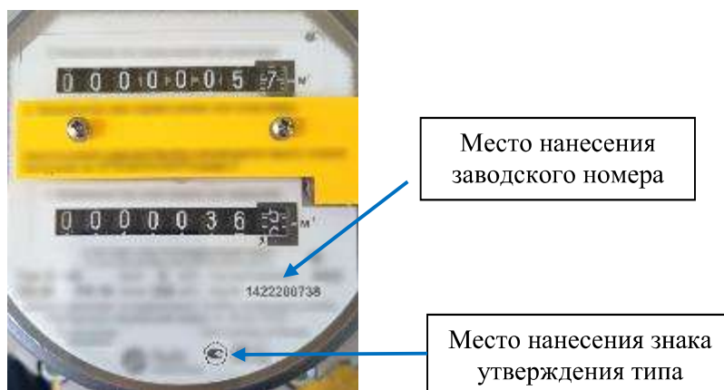
Рисунок 2 – Места нанесения заводского номера, знака утверждения типа для счетчиков в исполнении «Р»
