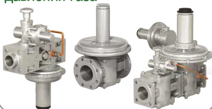
Модульные системы позволяют поставить потребителю как отдельно регулятор-стабилизатор, так и в комплекте с предохранительно-запорным (ПЗК) и (или) предохранительно-сбросным (ПСК) клапаном. Наличие в регуляторе сменных пружин позволяет добиться более точной настройки величины выходного давления по отношению к регуляторам промышленного типа.
