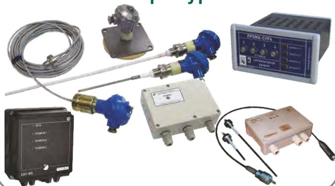
Предназначены для непрерывного, в т. ч. бесконтактного высокоточного измерения уровня различных жидких и сыпучих продуктов: светлых и темных нефтепродуктов, нефти, любых проводящих и непроводящих жидкостей, едких химических реагентов и их растворов, растворителей, паст, красок, в товарных и технологических резервуарах, в т. ч. и в емкостях, находящихя под избыточным давлением.
