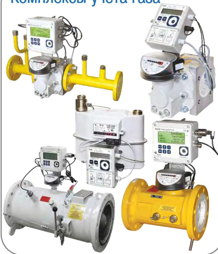
Предназначены для измерения объема газа, приведенного к стандартным условиям путем измерения входящим в состав комплекса счетчиком газа объема газа при рабочих условиях и автоматической электронной коррекции по измеренным значениям температуры или температуры и давления газа, вычисленного электронным корректором по ГОСТ 30319 или подстановочному значению коэффициента сжимаемости газа.
